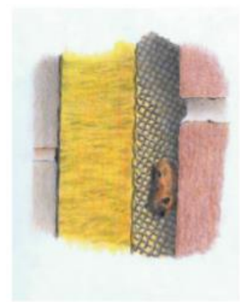
Ingemetselde geschakelde inbouwkasten voor vleermuizen en vleermuisvriendelijk isolatiemateriaal (met grip). Brochure 'Vleermuisvriendelijk bouwen', Zoogdierverseniging.
