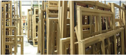
hergebruikte kozijnen met 3V glas
